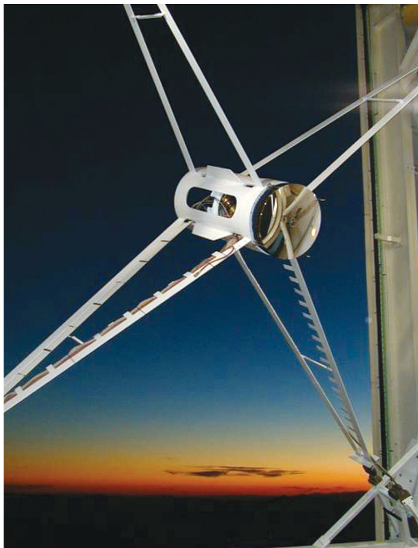
Abb. 1 Das Herzstück der adaptiven Optik des 6,5-m-Teleskops auf dem Mount Hopkins in Arizona: der adaptive Sekundärspiegel mit 336 Aktuatoren montiert am Frontring des Teleskops. (Foto: L. Close, Steward Observatory, Arizona)
